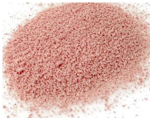
Figura 13. Aspectul noului polimer sintetizat PAAA-CL-XLD
