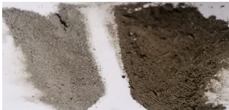
Figura 18. Aspectrul prafului de piatră SD (stânga) și al noului compozit sintetizat BPSD (dreapta) (Ganea & Nan, 2023b)
