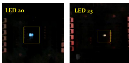
Figura 4.6: stânga - configurația LED 20 (ITO/PEDOT-PSS/ PolyTPD/CDs-PDA-F3 /Al); dreapta - configurația LED 23 (ITO/PEDOT-PSS/ PolyTPD/CDs-PDA-F3 tratat cu UV-O 3 /Al)
