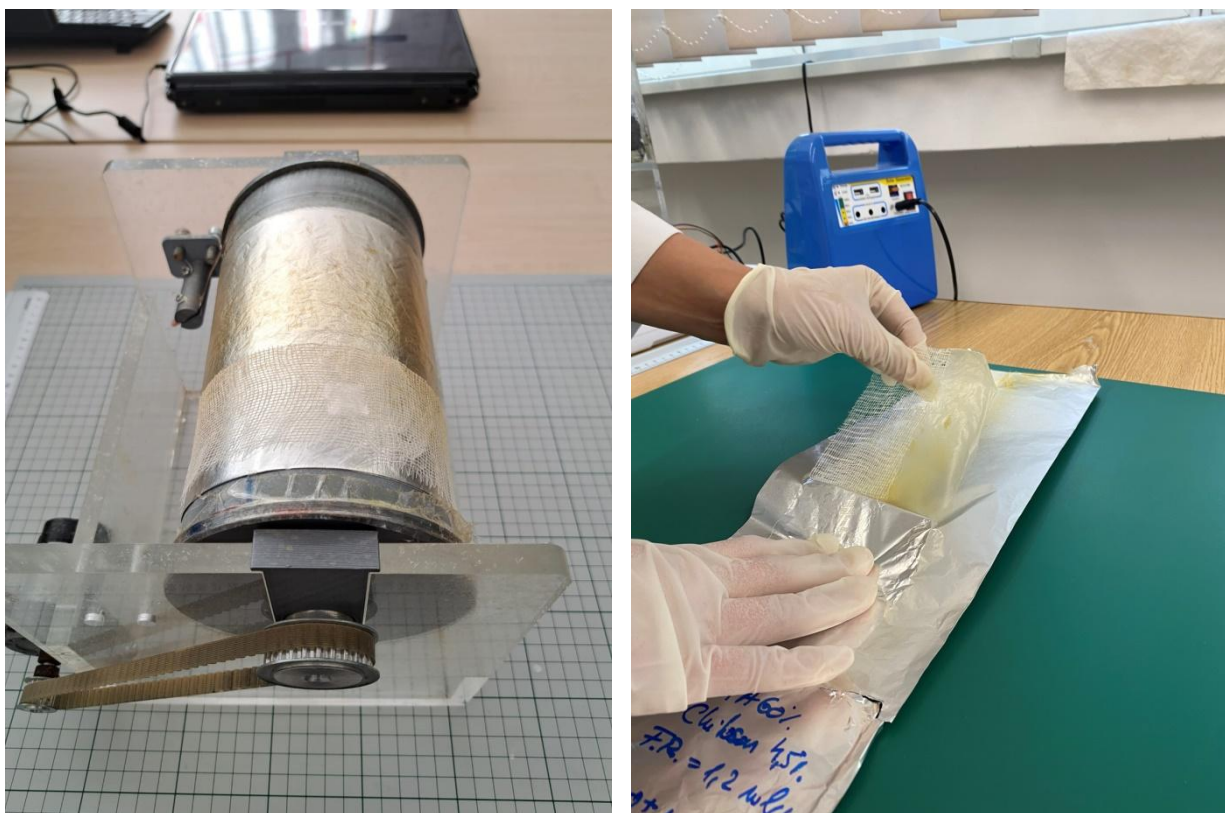
Fig. 5.2. Obținerea nanofibrelor pe baza de chitosan.
