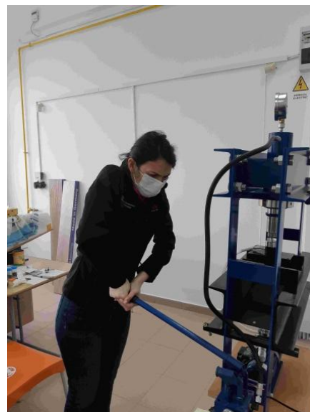
Fig. 3.6. a) Spectrele FT-IR ale probelor V1, V2 și V3 și b) Prepararea probelor pentru măsurătorile de FT-IR [21].
