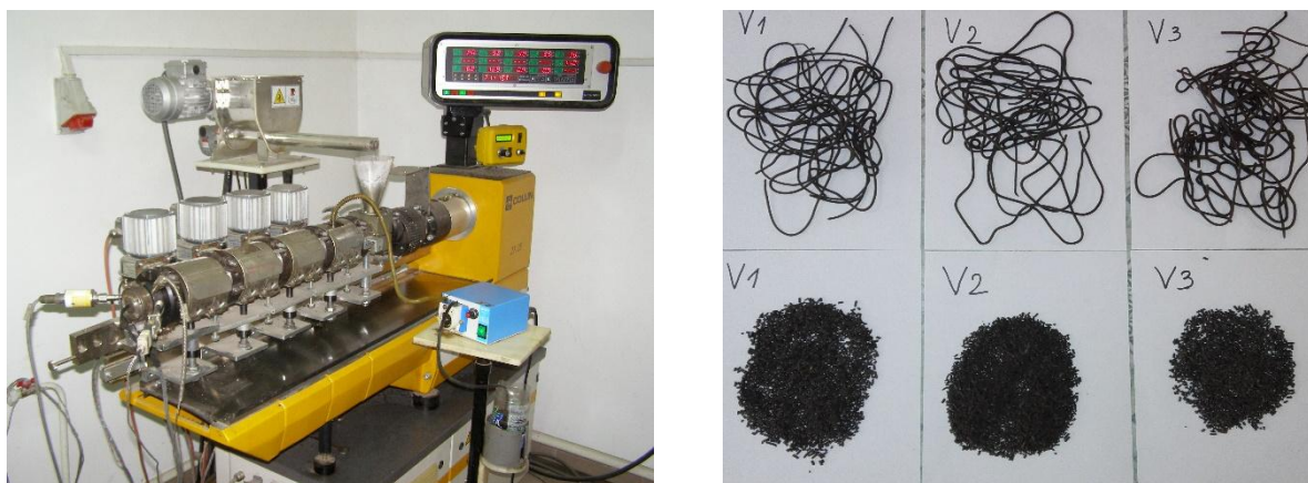
Fig. 1.2. a) Dispozitiv de producere a fertilizatorilor organo-minerali pe bază de biosolide localizat la INMA București Filiala Cluj-Napoca și b) fertilizatorii organo-minerali pe bază de biosolide (V1, V2, V3) produși de INMA București Filiala Cluj-Napoca [13, 14].
