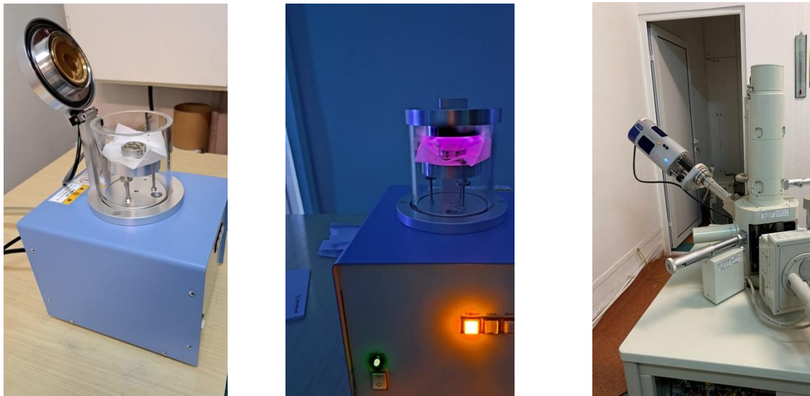
Fig. 2.3. a) Prepararea probelor pentru analiza SEM b) Microscopul SEM JEOL JSM 5600LV cu scanare prin baleiaj.
