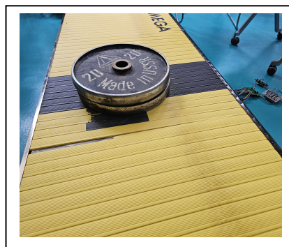
Figura nr. 10 - Etalonarea soluției tehnice utilizând discuri cu greutatea de 20 kg
