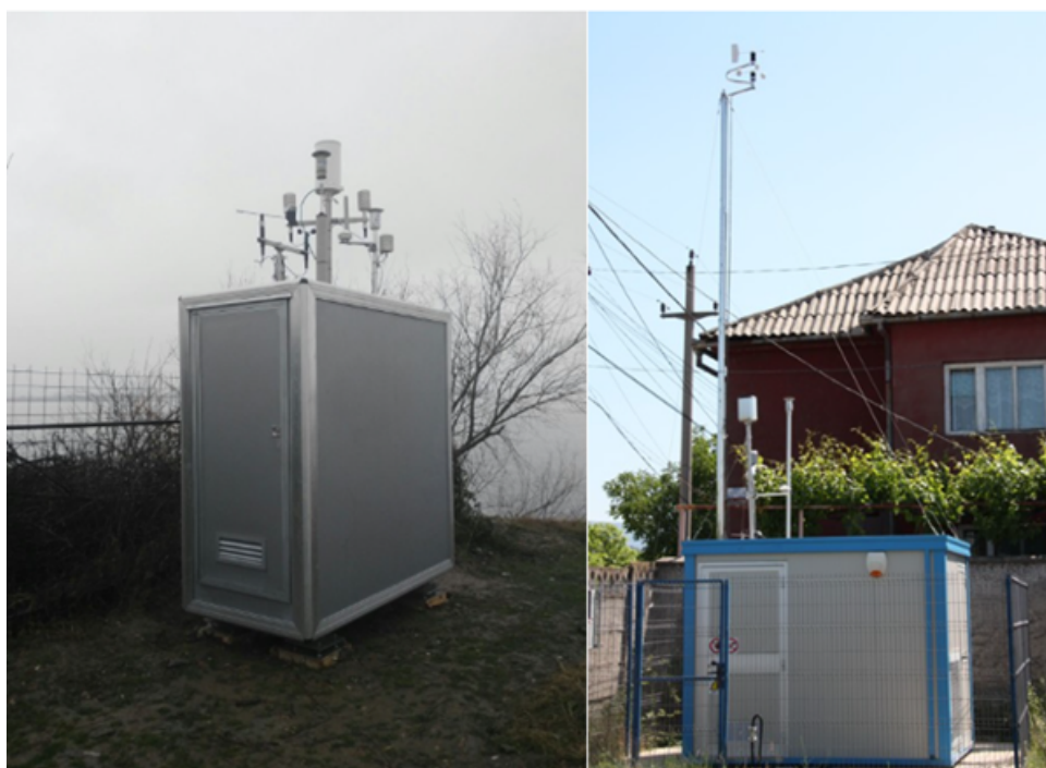
Figure 2.8: Stația de calitate a aerului CS5 (stânga) și stația de calitate a aerului CS3 (dreapta) a Rețelei Naționale de Monitorizare a Calității Aerului (RNMCA) folosite în timpul monitorizării in-situ în jurul iazul de decantare închise Moldova Nouă, România
