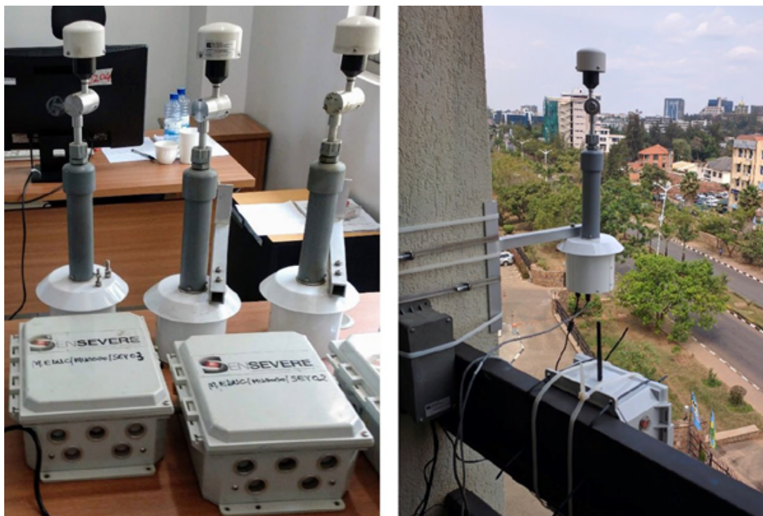
Figure 2.4: Monitoare de calitate a aerului multi-poluanti (RAMPs) în laborator pentru ajustare și întreținere (stânga) și RAMP instalat pentru monitorizare in-situ la marginea drumului (dreapta). Fotografie realizată de Subramanian et al. (2020)
