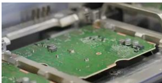
Figura 2. Exemplul unui anamblu PCBA populat cu componente [5]
