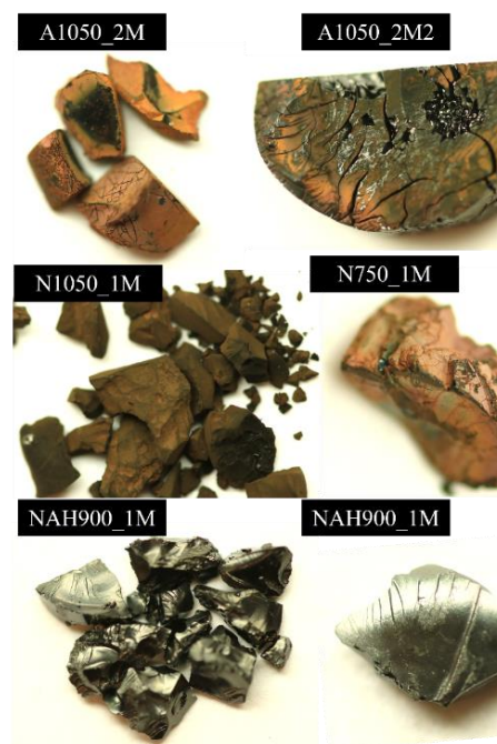
Figura 9.1. Monoliți CXBiFe după piroliză sub (a) Ar, (b) N 2 și (c) N 2 / Ar + H 2 la diferite temperaturi
