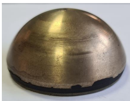
Figura 5.13 Pivotal care alunecă pe suprafețele PF-urilor.
