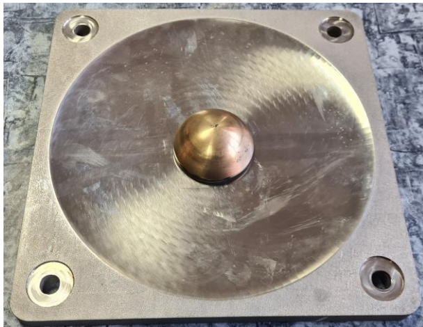
Figura 5.11 Pendul sferic de fricțiune cu raza R=810 mm.
