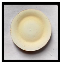
Fig.3.1.1 Eroziune circulară pe suprafața țintei
