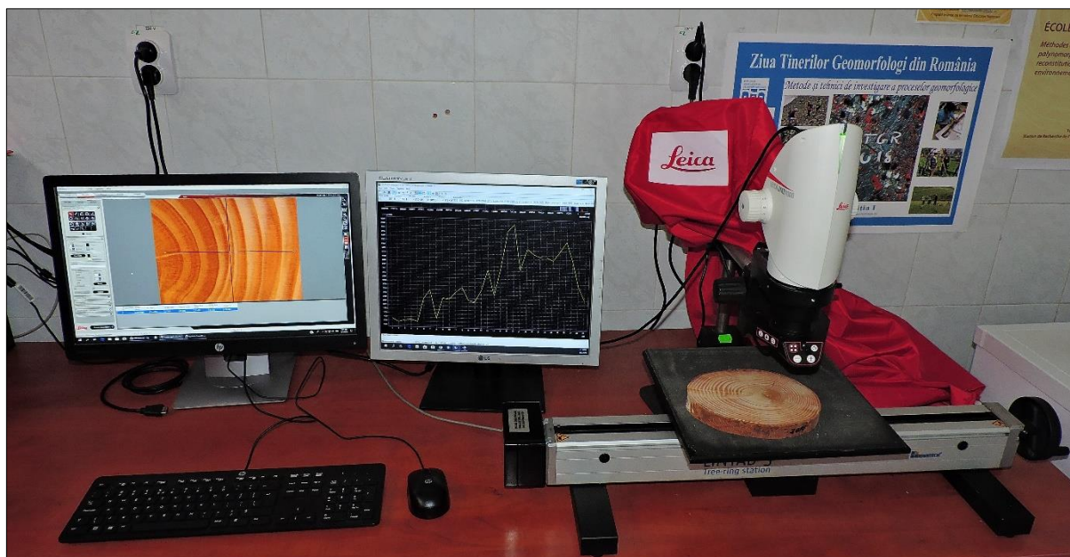
Fig. 11 Stația LINTAB 5 cu microscopul Leica DMS1000 conectat la calculator
