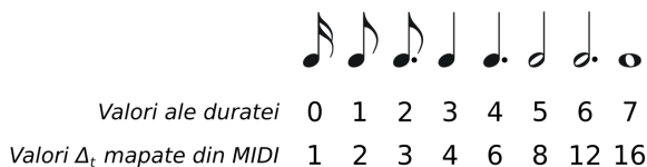
Figura 2.2. Valori discrete ale duratelor notelor unui model redus, împreună cu valorile MIDI corespunzătoare, presupunând 4 unități pe sfert de notă și un tempo de 120BPM.
