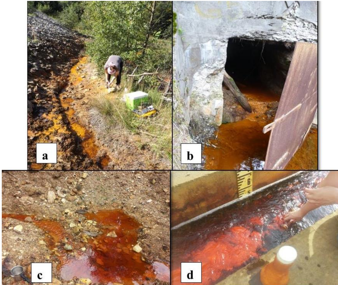
Figura 4. a,b,c,d – ape de mină din zona Roșia Montană (a - exfiltrații bază iaz Săliște, b - Galeria RO88, c - Galeria Cetate, d - Galeria 714).
