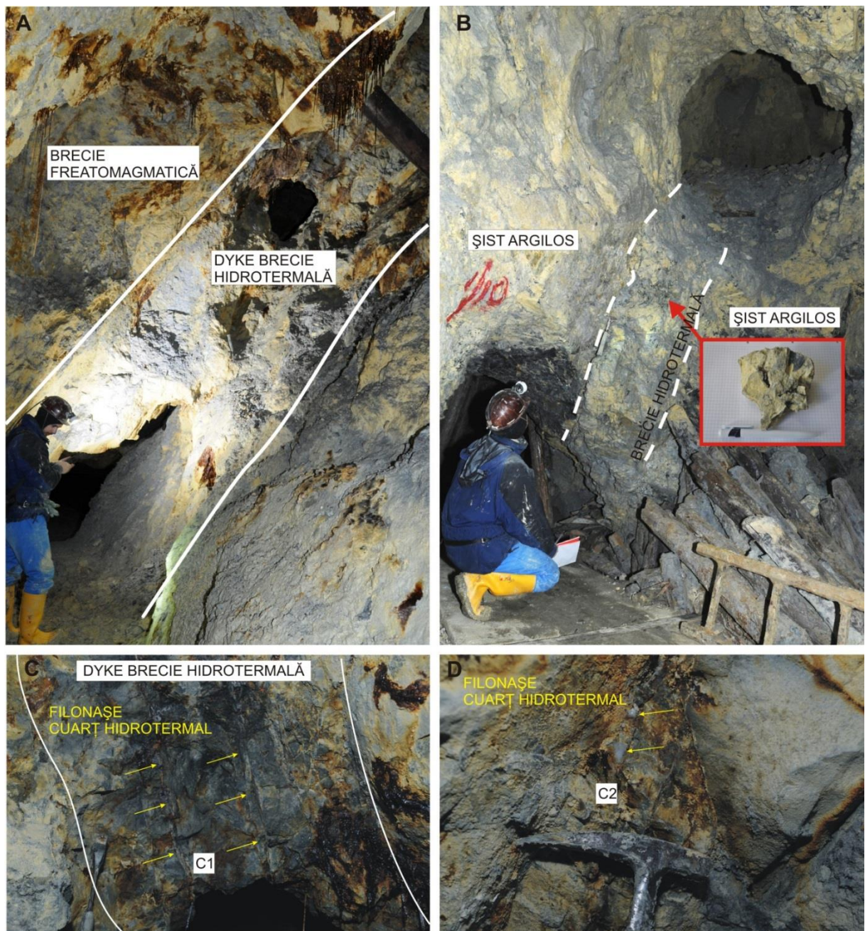
Fig. 5. Structuri de breccii hidrotermale mineralizate în sectorul Coș. A) dyke de breccie hidrotermală cantonat în structura de breccie polimictică freatomagmatică exploatat în Coranda Mare; B) dyke de breccie hidrotermală deschis prin lucrări de exploatare în Coranda Mică - în chenar, detaliu al brecciei hidrotermale ilustrând aspectul clast supported al brecciei, cu spații libere abundente; C) filonașe de cuarț hidrotermal ce străbat dyke-ul de breccie hidrotermală exploatat preferențial în camera de exploatare Coranda Mare; D) detaliu al unui filonaș de cuarț ce intersectează structura de breccie hidrotermală prezentată.
