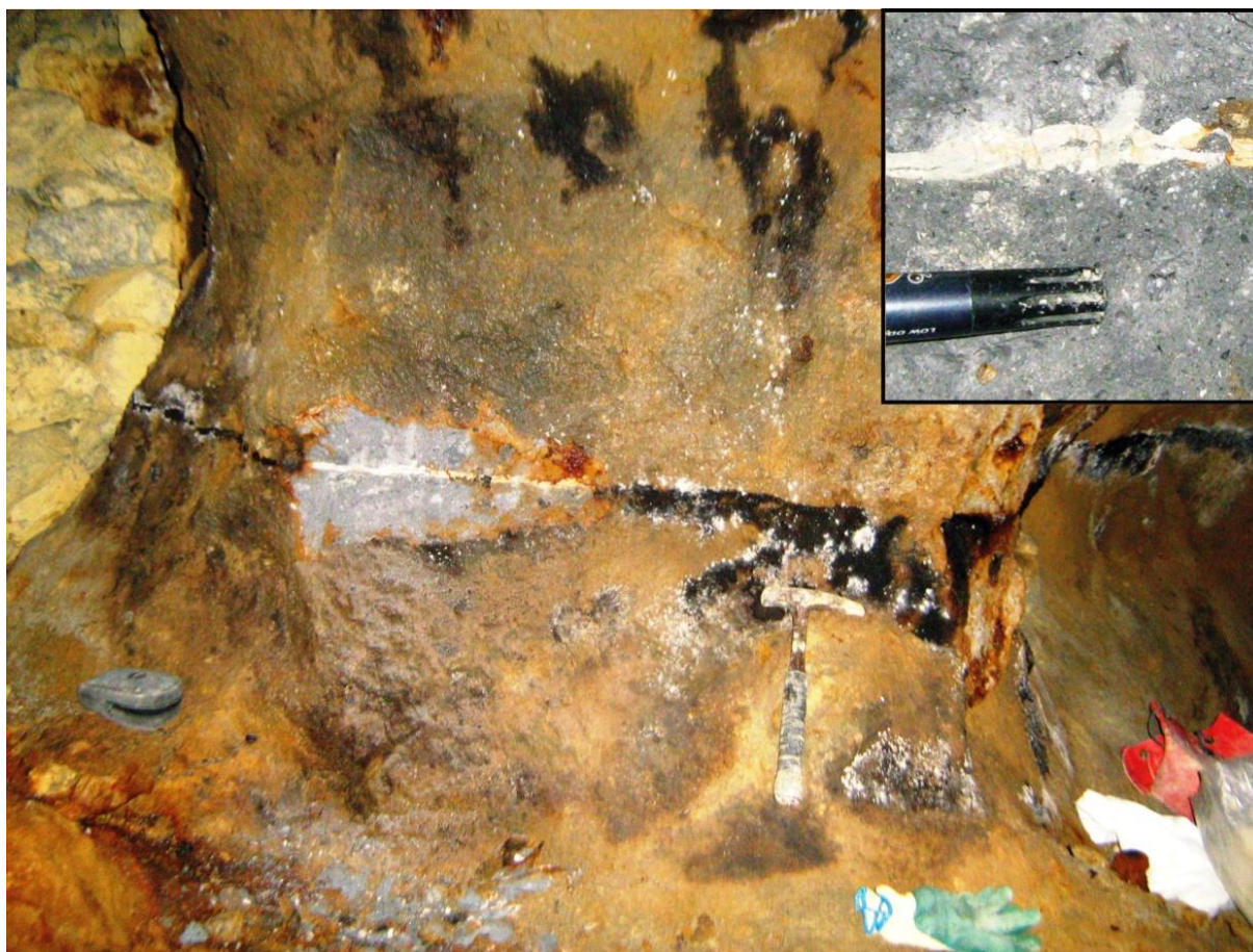
Fig. 19. Pilier de protecție vertical în care este vizibil un filon suborizontal de rodocrozit cantonat în vent breccia. Se remarcă pelicula de oxizi-hidroxiți de mangan formată pe suportul rodocrozitului și culoarea caracteristică a carbonatului de mangan care apare după „curățarea” aliniamentului negru (chenar stânga sus). În stânga pilierului se observă rambleierea spațiului exploatat. Filonul are un conținut de 101 g/t Au.
