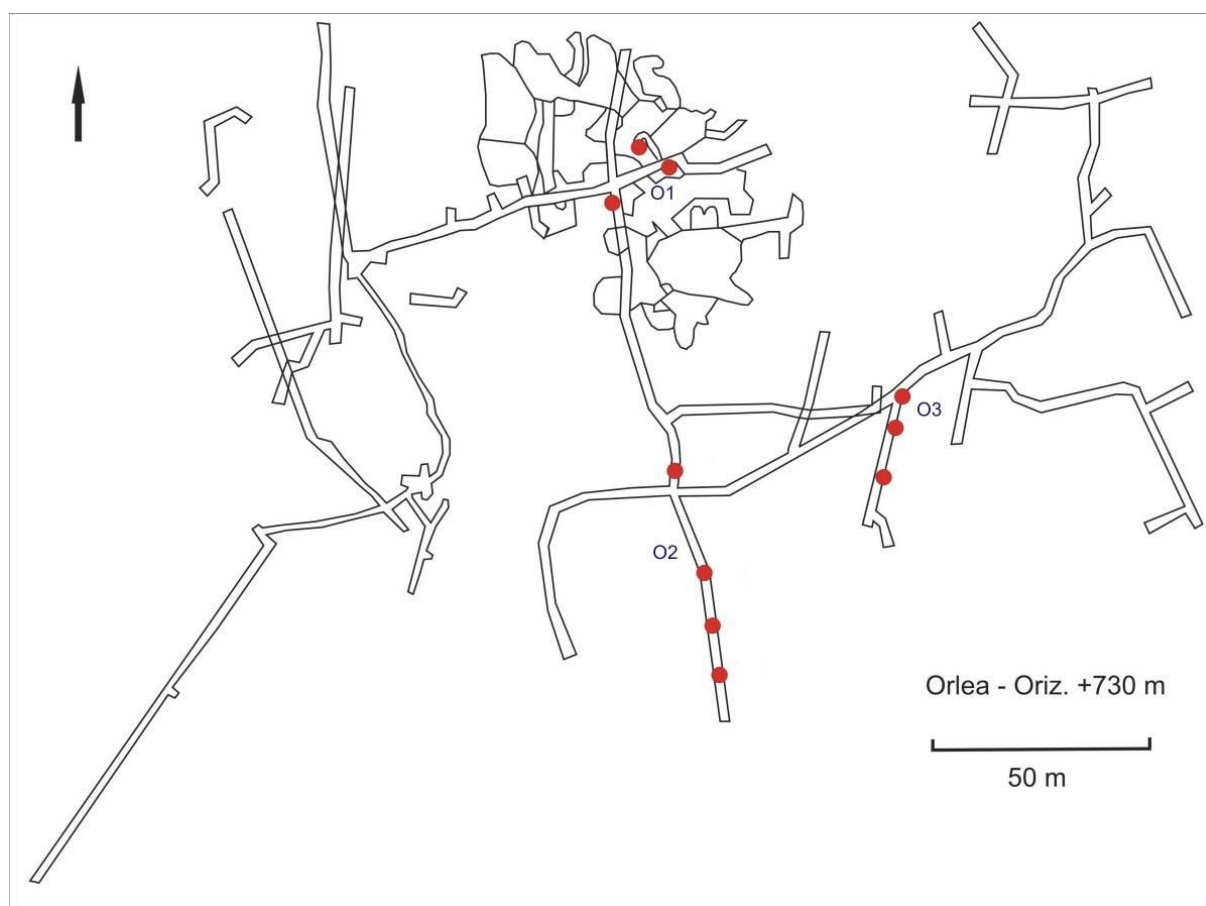
Fig. 18. Harta topografică a lucrărilor miniere subterane din sectorul Orlea, orizontul +730 m, cu localizarea zonelor probate. Baza topografică a fost preluată din documentația pusă la dispoziție de compania RMGC.
