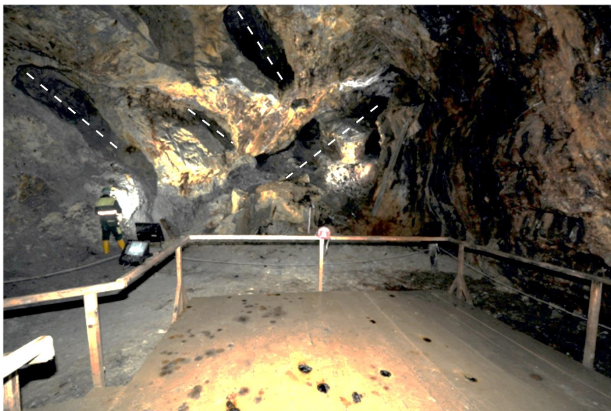
Fig. 6. Imagine de ansamblu a Corandei Mari, cu semnalarea poziției dyke-urilor de brechie hidrotermală (linie punctată) pe peretele nordic al acestei camere de exploatare.
