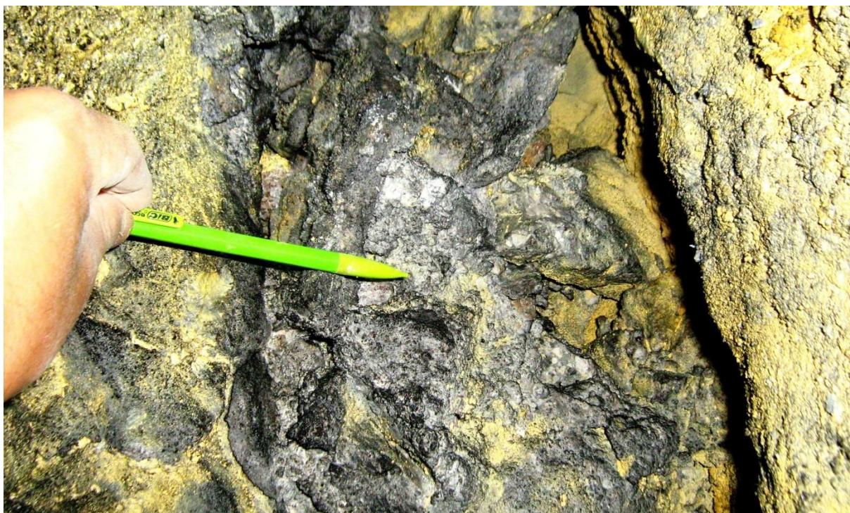
Fig. 21. Detaliu al structurii breccia dyke de natură tectonică de la orizontul +730 m, sectorul minier Orlea.
