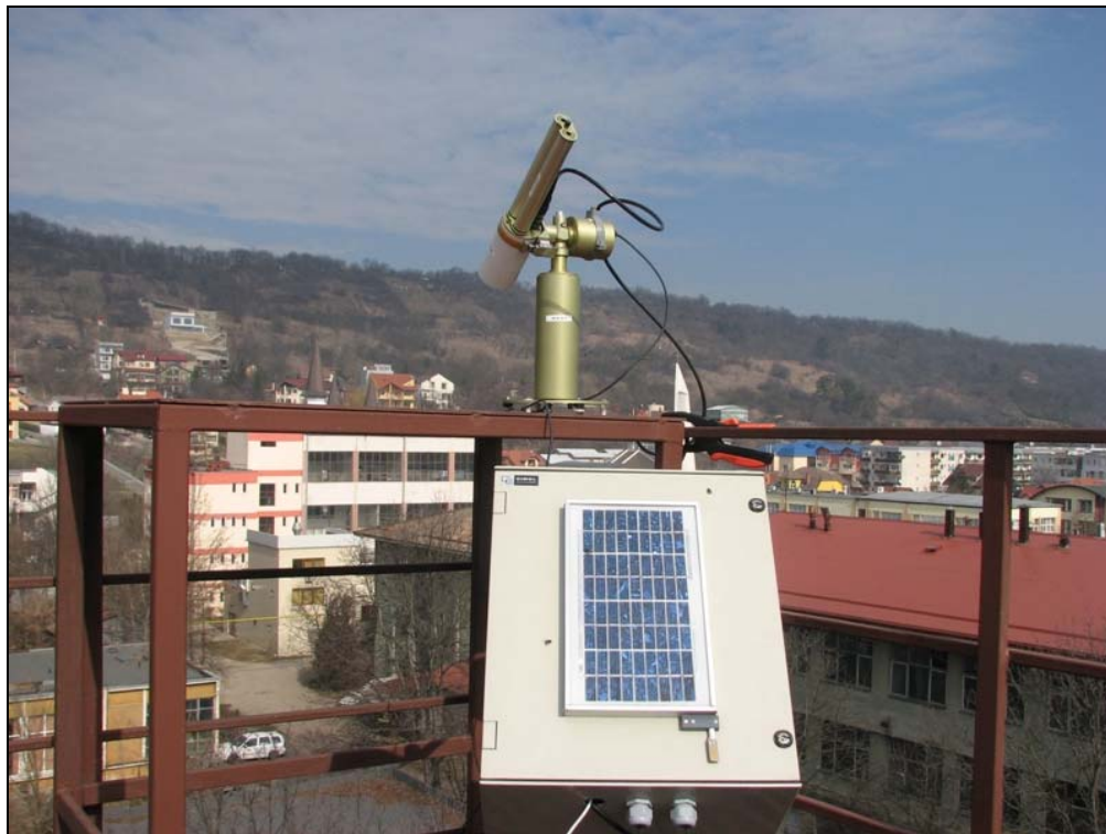
Figura 3.11 - Fotometrul solar Cimel CE 318, NASA-AERONET # 643 Facultatea de Știința și Ingineria Mediului, Universitatea Babeș-Bolyai Cluj-Napoca (Ajtai et al., 2012b)
