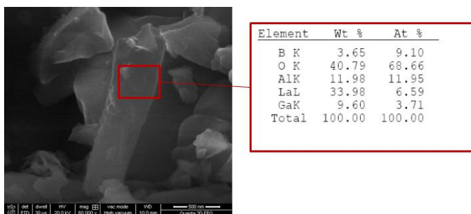
Fig. 5 Imaginea SEM și rezultatele EDX pentru proba tratată 30 min la 900^\circ\text{C}
