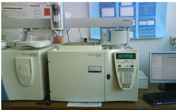
Fig. 2.7. Sistemul Thermo Finnigan Trace GC-Trace DSQ echipat cu autosampler
