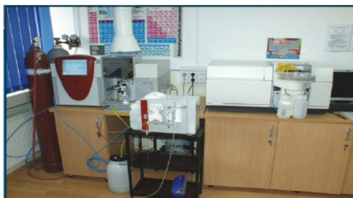
Fig.5.3.2 – a) Sistem de digestie cu microunde CEM Mars 5 și b) Spectrofotometru cu absorbție atomică Zeenit 650
