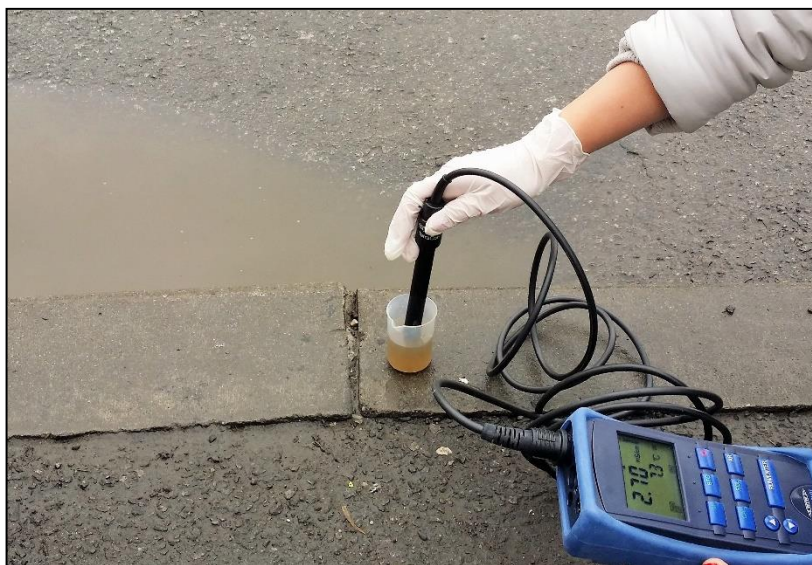
Fig. 8. 1 Măsurătorile realizate în teren cu ajutorul unui pH/Cond 340i metru (WTW Handheld Multi-Parameter Instrument) (Ivan et al., 2016).
