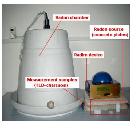
Figura 6.: Camera de radon folosită în laboratorul de cercetare al Universității Babeș-Bolyai
