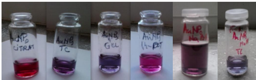
Figura 2.2. Variația culorii pentru nanoparticulele de aur cu diferiți liganzi
