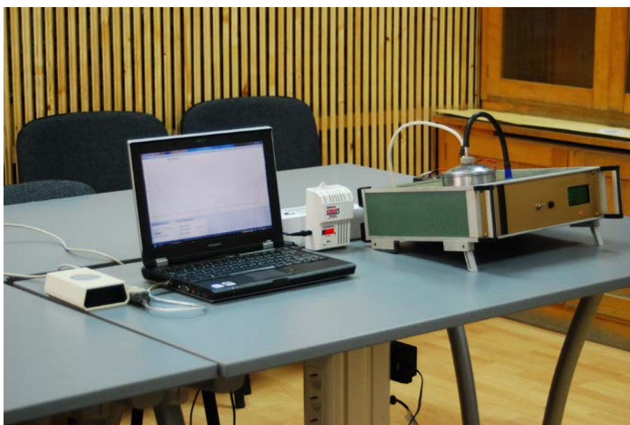
Fig. 2.20. aparatul de măsurare a concentrației de Radon cu cameră de ionizare, în teste alături de un aparat Safety Siren 2 și un contor Geiger Muller (original)
