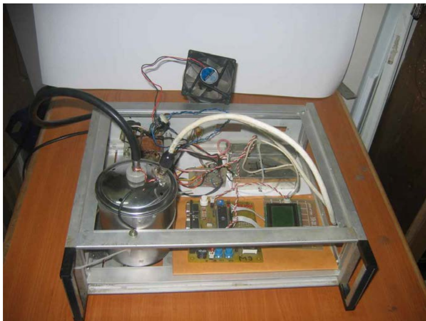
Fig. 2.19. aparatul de măsurare a concentrației de Radon cu cameră de ionizare, vedere în interior (original)
