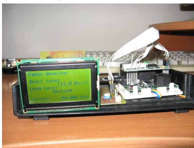
Fig. 2.16. aparatul de măsurare a conținutului de Radon în aer cu cameră de detecție (vedere din față) (original)
