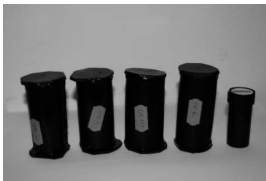
Fig. 3.32. traductori CR 39 plasați în subsol, (original)
