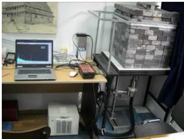
Fig. 6.6. Detector ORTEC GMX HpeGe FWHM 1.92KeV at 1.33MeV cu fereastră de Be Detectorul are o rezoluție de 1.92keV la energia de 1.33MeV a Co-60 și o eficiență relativă 34.2 %.
