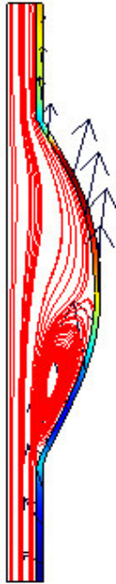
Figura 8.2 Arteră cu anevrism. Linile de curent și deplasarea peretelui la un moment dat în cazul modelului vâscoelastic
