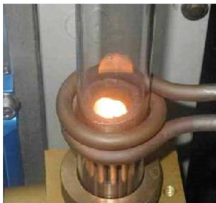
Fig 2.1 Cuptorul cu inducție și schema principiului de funcționare al acestuia [RÖM08]
