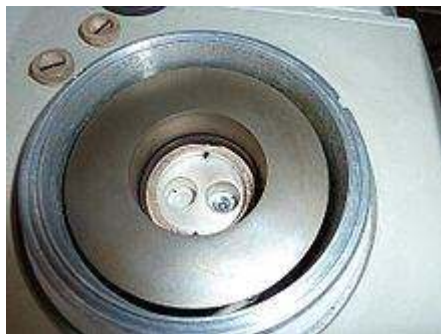
Fig 2.11. Fotografie a cuptorului utilizat la efectuarea DSC.
