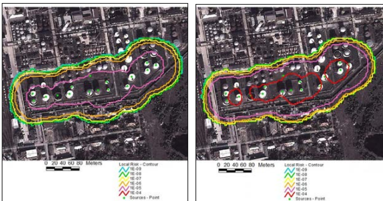
Figura 56. Comparația dintre riscul individual în scenariul de incendiu în cuva de retenție pentru rezervoarele A1-A15. Stânga - cauze intrinseci, Dreapta-total (cauze intrinseci și NaTech)
