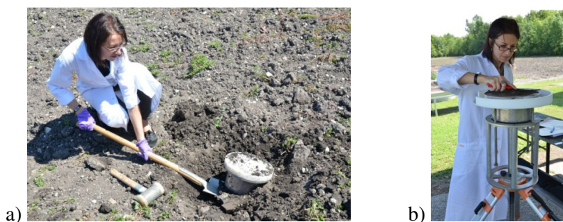
Figura 7. Profil de sol în interiorul tubului de inox al FSIC: (a) în timpul prelevării probei, și (b) în timpul răzuirii incrementale
