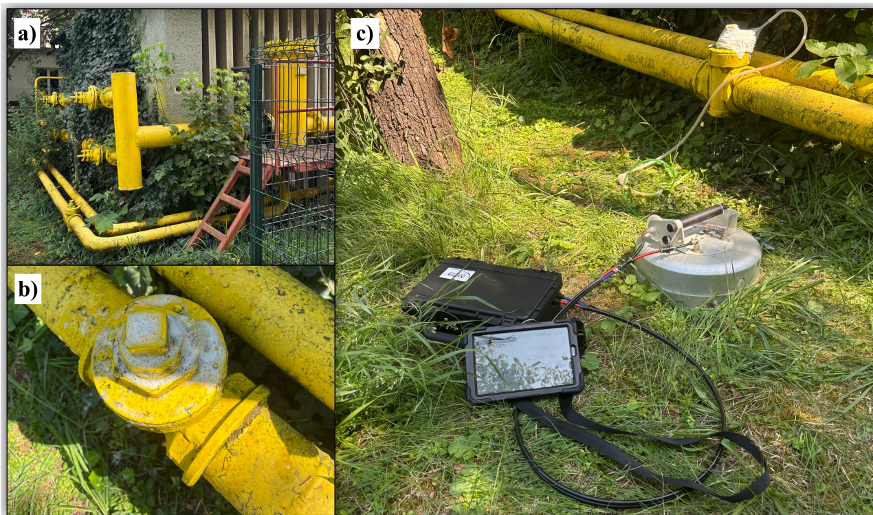
Figura 3.4. Stația de compresoare a conductei de gaze naturale (NG) (a), punctul de scurgere identificat prin bule observate (b), și tehnica de etanșare a scurgerilor în cameră statică izolată de partea inferioară (c).
