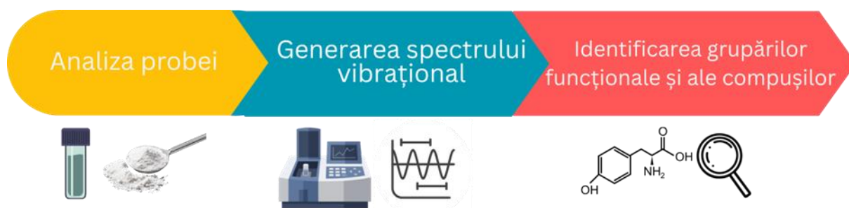
Figura 1.2. Fluxul de analiză pentru obținerea spectrelor IR ale probelor. În funcție de starea de agregare a probei aceasta se poate plasa pe cristal ATR, se poate prepara o pastilă cu KBr sau se poate utiliza o cuvă pentru lichide. După plasarea probei are loc interacțiunea acesteia cu radiația IR și obținerea spectrului IR.
