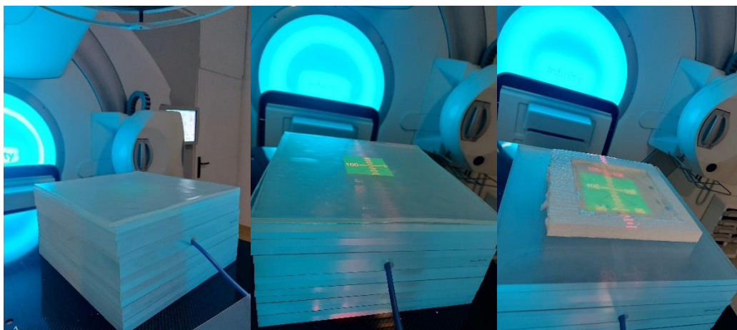
Cifră IV-4 Ilustrare fotografică a configurației experimentale utilizate pentru analiza materialului bolus și evaluarea consistenței.
